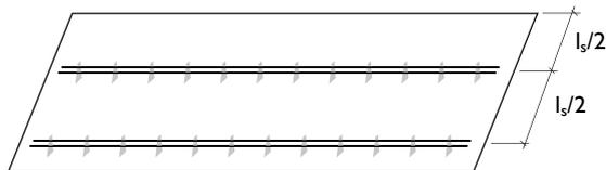
Abb. 3: gleichmäßige Verteilung mehrerer Schneefangsysteme
