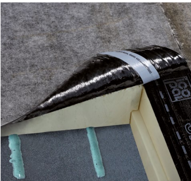
Dachaufbau mit Sicherheitsdämmbahn Polar-PIR, also Zwischenlage Polar und PIR-Dämmstoff in einem
