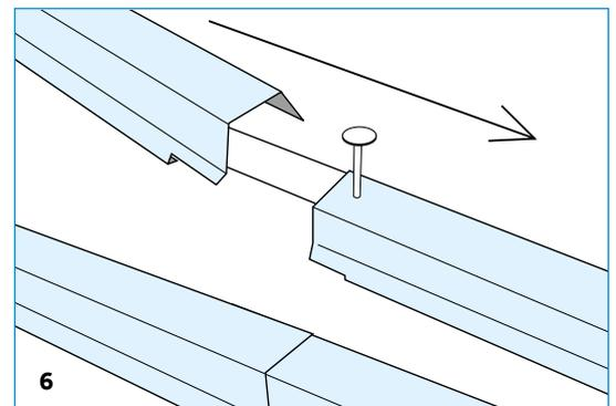
Zum Abschluss die Ortgangprofile auf dem Windfangbrett verlegen.
