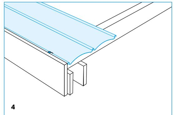
Die folgenden Platten mit der großen auf die kleine Wulst der bereits verlegten Platte aufdrücken. Dann die Seite mit der kleinen Wulst auf die Topclips drücken usw.
