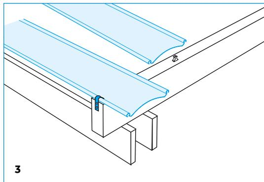
Die erste Platte Fastlock Uni auf die Topclips aufdrücken, dabei muss der große Wulst am Rand liegen. Zusätzlich am Rand einen Seitenbeschlag setzen.
