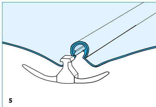
Bei Dachneigungen unter  $3^\circ$  im Traufbereich zusätzlich Tropfnasen anbringen.
