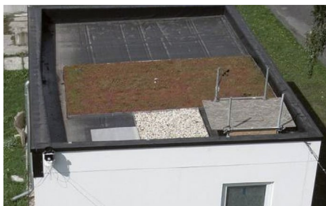
Versuchsstand mit den untersuchten Deckschichten
